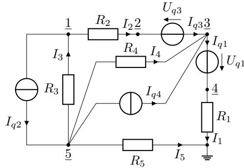
wobei wieder die für das Verfahren relevanten Knoten mit 1–5 explizit nummeriert, und die Ströme  $I_1, I_2, I_3, I_4, I_5, I_{q1}, I_{q2}, I_{q3}$  eingezeichnet wurden.
