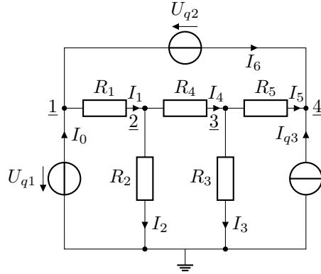
wobei die für das Verfahren relevanten Knoten mit 1–4 explizit nummeriert, und die Ströme  $I_0, \dots, I_6$  eingezeichnet wurden.
